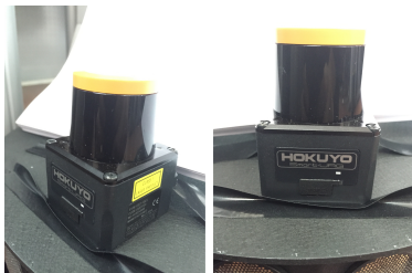
图：HOKUYO 激光传感器照片与性能参数
